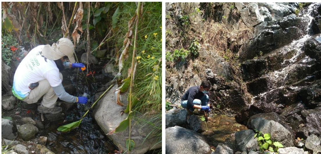
Figura 4 Toma de muestras de agua para análisis en el laboratorio y medición de parámetros in situ (AMSCLAE/DICA, 2021).
