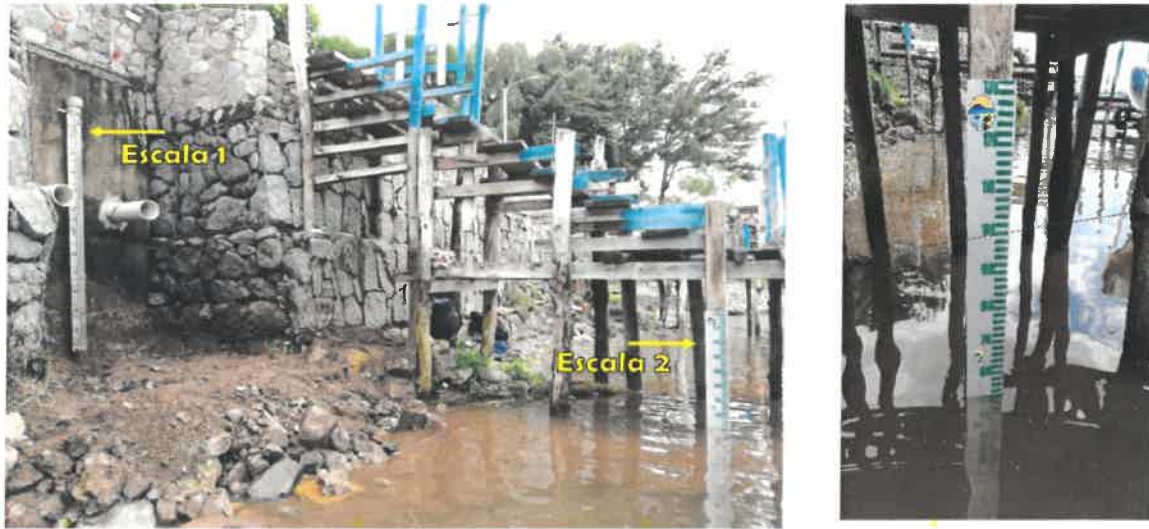
Figura 5. Instalación de escala con base a la escala del IGN 2019.
