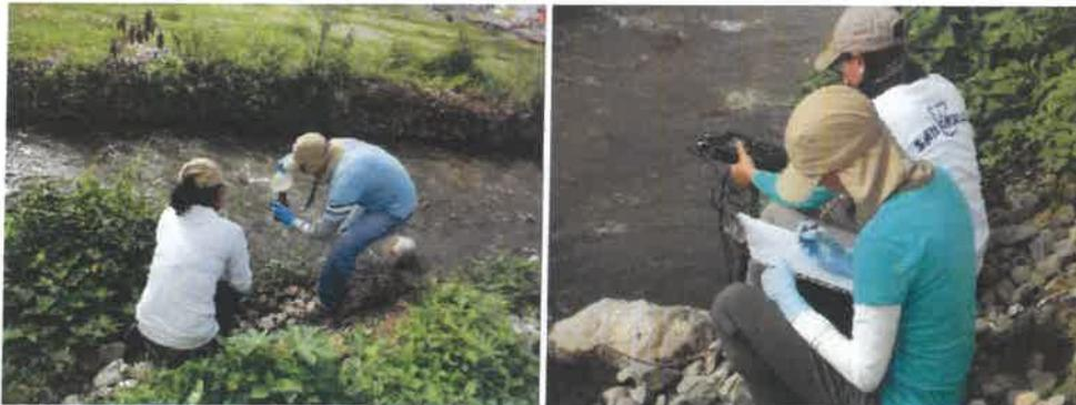
**Figura 5** Toma de muestras de agua para análisis en el laboratorio y medición de parámetros in situ (AMSCLAE/DICA, 2019).
