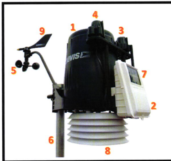
Figura 2. Componentes de estación climática DAVIS Vantage PRO2 (DAVIS, 2013)
